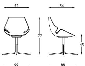
Sedia ideale per il mondo contract, ufficio e per il settore casa. Scocca in poliuretano rigido TECH, colorato. Disponibile su telaio 4 gambe cromato, su telaio slitta cromato, su gas e base a 5 razze in alluminio con ruote o su telaio girevole in tubolare d'acciaio. Versione su panca da 2 / 3 / 4 posti. Sgabello fisso con telaio cromato o con gas e base rotonda cromata. La scocca può essere anche imbottita e rivestita.
